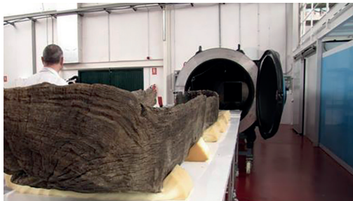
Liofilizador do laboratório da Arquatec, laboratório especializado em restauração de objetos arqueológicos húmidos | Na imagem Piroga Lima 2 | Foto - Adolfo Martins/CNANS
